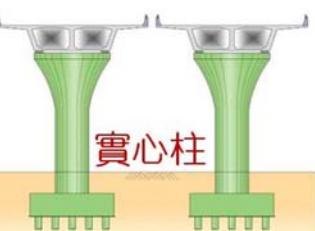
PC箱型梁、施工性、節減材料、減輕自重
